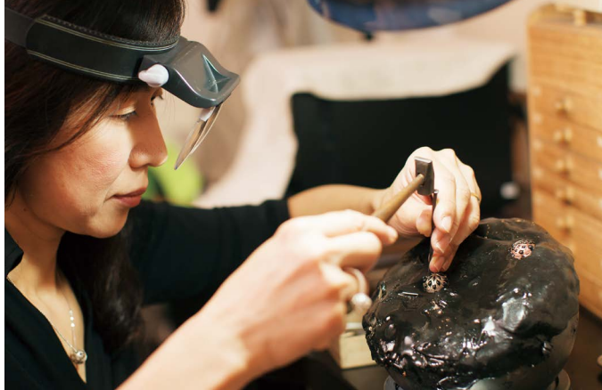
工房での制作風景。文様を彫る際は、一旦熱して柔らかくした松ヤニに金属片を埋め込んで固定する。
