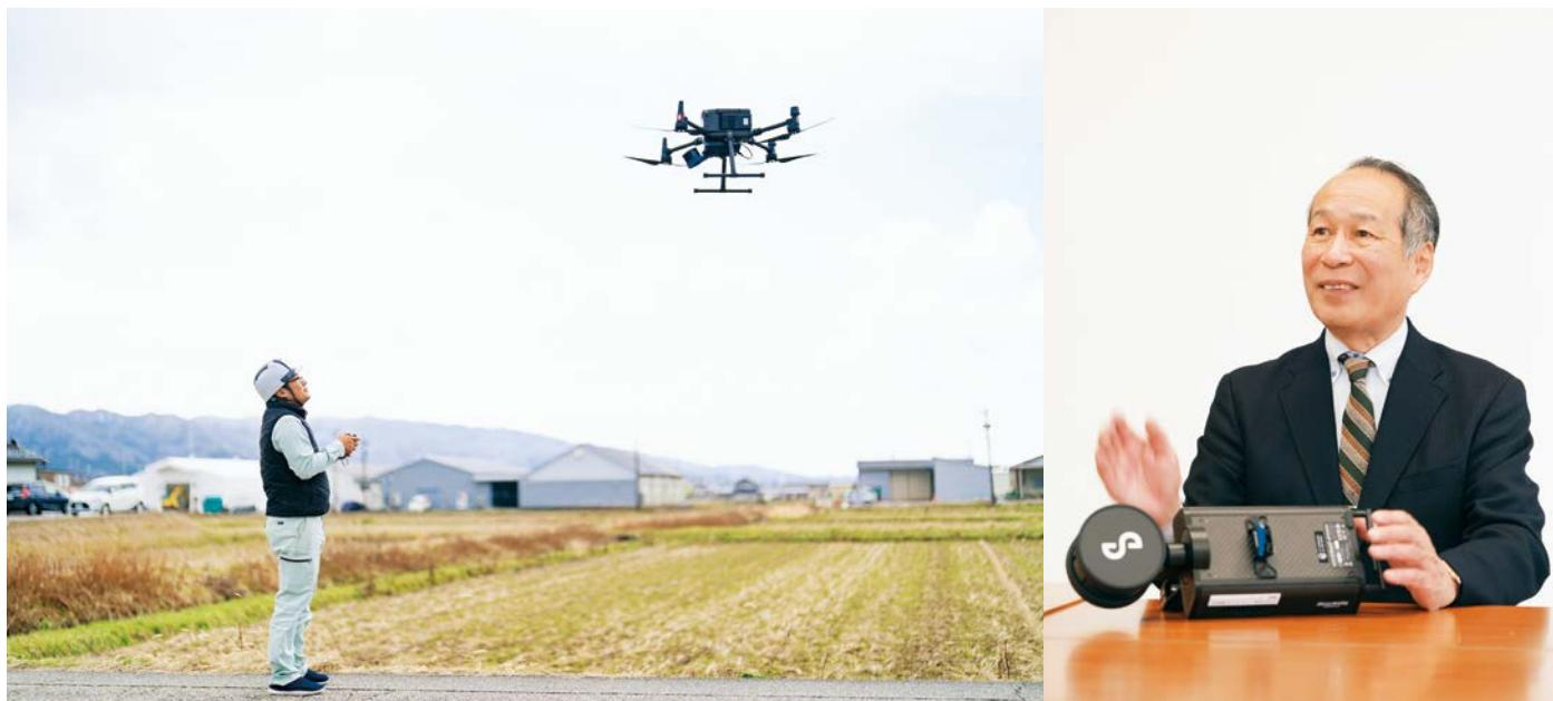
写真左)SLAM式LiDARを搭載して飛行するドローン。立ち入りの難しい災害現場などでも活躍する。
