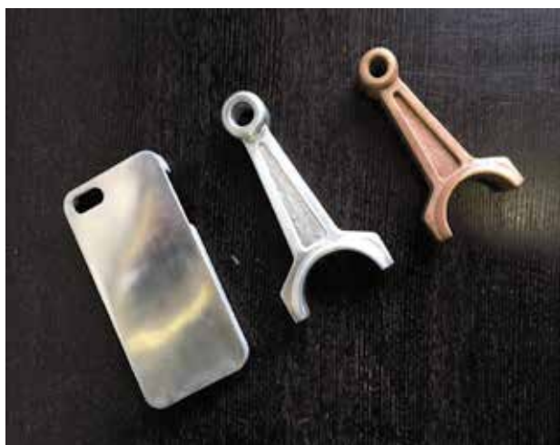
3Dプリンター出力品(紙)への溶射加工
