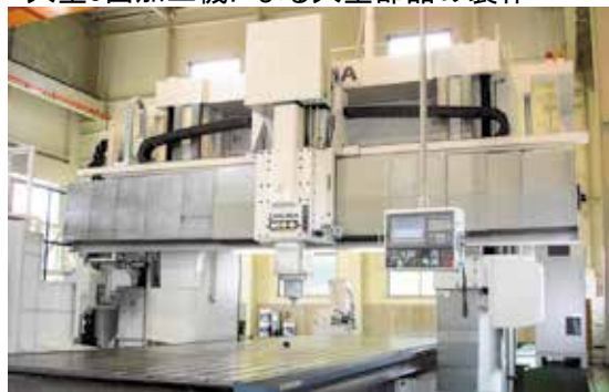
・大型5面加工機による大型部品の製作
