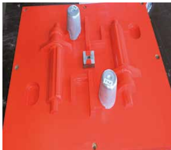
アルミなど溶射した木製パーツを型に装着
