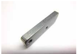
写真①: 全せん断加工サンプル 材質: SUS、サイズ: W11.4, L32.0, t4.0
