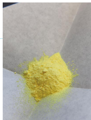
金属素材に代わるリチウム電池の正極用新素材として期待が高まる有機硫黄ポリマー
