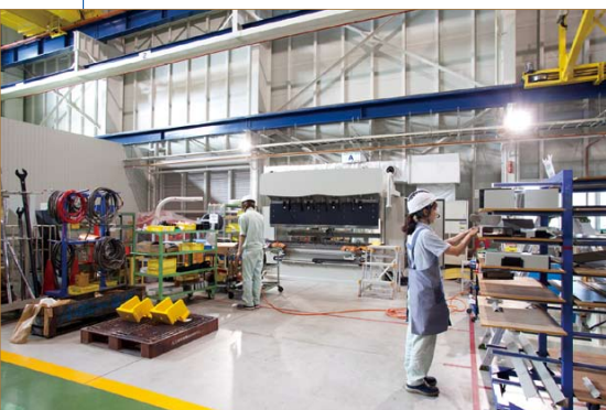
プレスブレーキを組み立てるセルステーション。セル生産方式の導入によって、社員の多能工化、作業の標準化が進んだ
