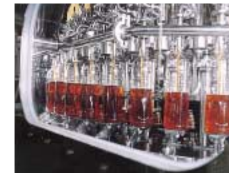
清涼飲料水や酒、調味料、化粧品などの液体をガラスや樹脂のボトルに充填するボトリングシステム。ここで培った自動化技術、レーザー技術を生かして事業を拡大する
