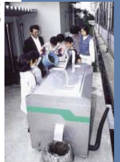
これから大いに成長が期待できる環境設備システム。写真は生ゴミなどの有機性廃棄物を発酵処理するシステム
