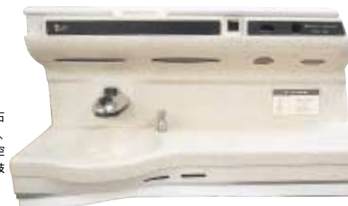
ビルドスが製造した人造大理石製洗面台。難燃性、軽量化など、20項目以上にわたる米連邦航空局の厳しい基準をクリアする技術力がビルドスの持ち味だ
