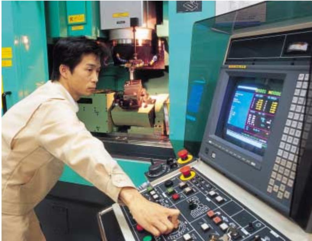
精密で迅速な金属加工を可能にした5軸マシニングセンター
