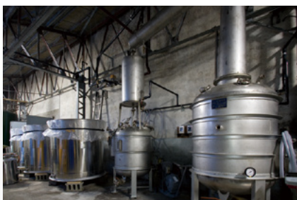
製造にあたって焼酎用の蒸留器（写真手前）や仕込用タンク（写真奥）を新たに導入した
