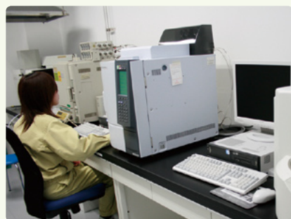
廃棄物の適正処理に向けて、ガスクロマトグラフ(写真奥)などで成分を分析
