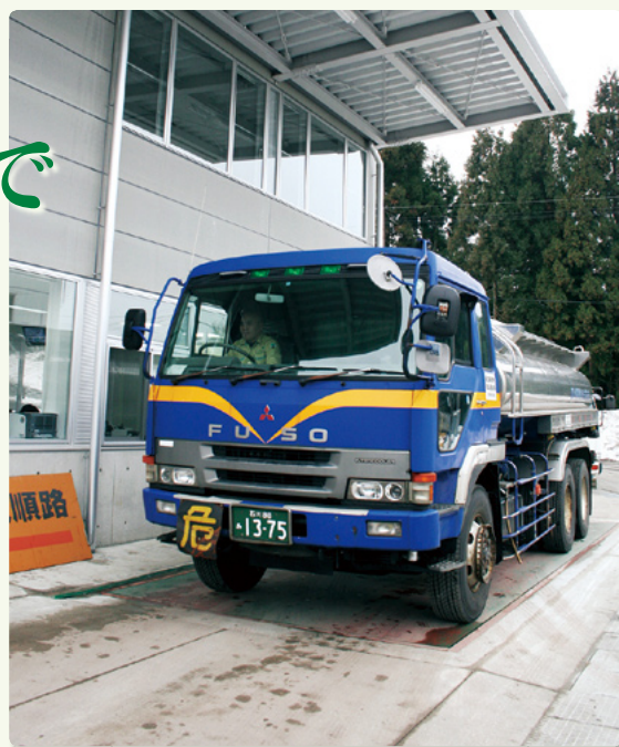
積載された廃棄物の重量を車体ごと計測するトラックスケール。計量器は地下に埋設されている
