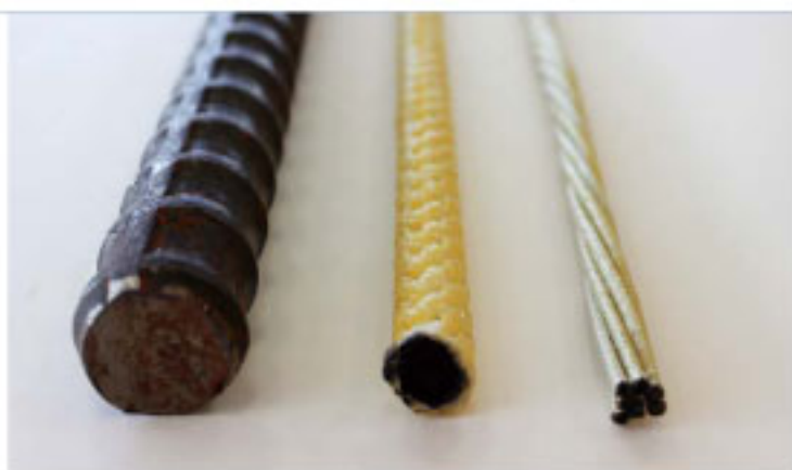
写真左から従来の鉄筋、新開発の建築材料、曲げ強度に優れるストランドロッド
