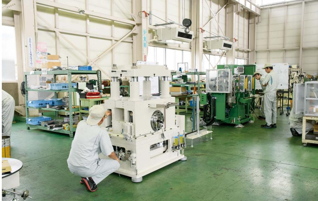
組立工場の様子。高精度を実現するため、一度組み上げた後でも試運転の結果が悪ければ、解体して組み立て直す。
