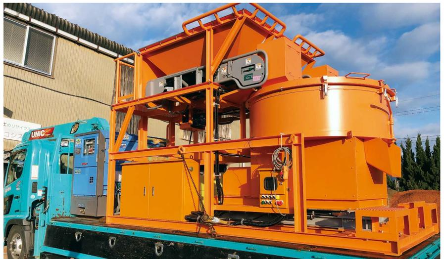
エコシステムが今後の事業の主力とする「モバコン」。車に載せて建設現場まで運搬可能で、自動運転により舗装材を製造する。
