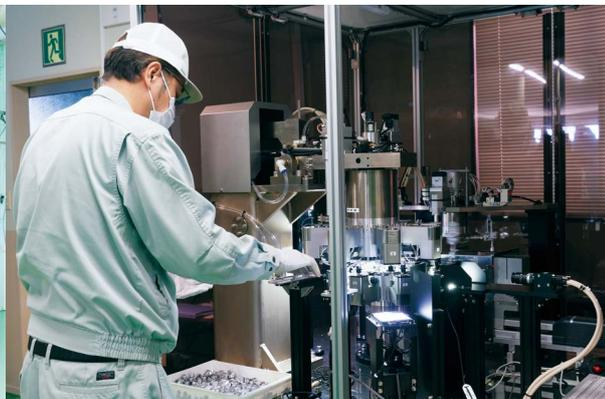
サポイン事業の助成金で購入した画像検査機。5つのカメラで表面の傷などをチェックする。
