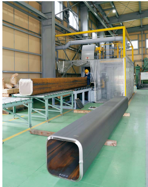
【写真左】長尺品を加工する通過式ショットブラスト機。2019年に整備した新工場に導入した。
