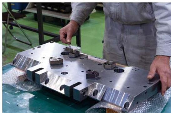
治具の組み立て作業。一つの治具には100~200個ほどの部品が組み付けられている。
