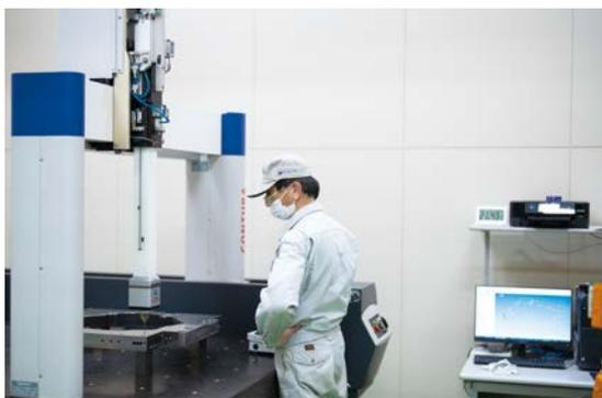
出荷前に各所の寸法を検査する3次元測定機。納品時には計測データを添付し、品質を保証している。
