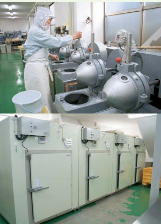
ISICOの設備貸与制度を活用して導入した生麩の練り機 (写真上)と製品を急速に冷凍するショックフリーザー
