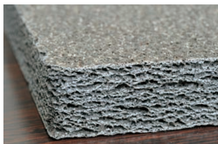
「グリーンビズ-G」に使われている超微多孔セラミックス材。1枚は50センチ角で厚さは25ミリと40ミリの2タイプ。素材全体に微細な気孔が分布している
