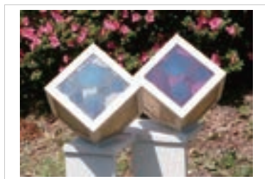
2 蓄電機能内蔵太陽電池を用いたスマートフォン充電器
