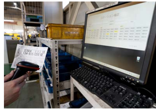
二次元コードを活用した在庫検索システム。部品の保管場所を即座に表示し、探す手間を解消した。
