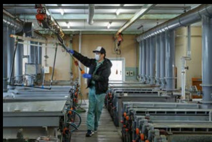
航空機部品にアルマイト処理を施し、耐食性や耐摩耗性を向上させる。
