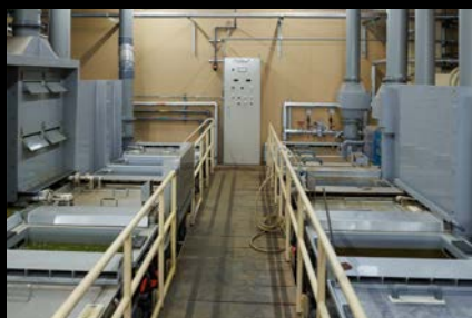
腐食しやすいマグネシウムの表面を皮膜処理するための設備。
